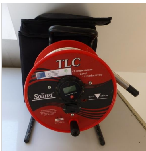
Obr. 30: Hladinomer s možnosťou merania teploty a mernej elektrickej vodivosti podzemnej vody
