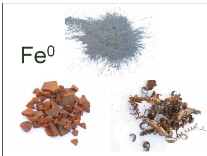
Obr. 35: Formy elementárneho Fe používané pri reaktívnych bariérach
