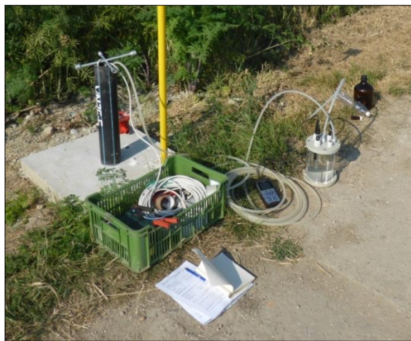
Obr. 29: Odber vzorky a meranie ukazovateľov pomocou multimetra a prietokovej cely
